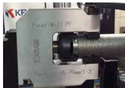
Aplicación retirada cladding en longitud 1".
