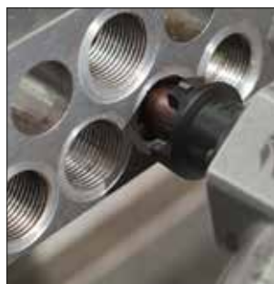
Re-mecaniza superficies de asiento en segundos.
