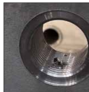
Todo tipo de material en caja de aguas pueden ser mecanizados con los insertos de carburo de la MiniMill 300GFF.
