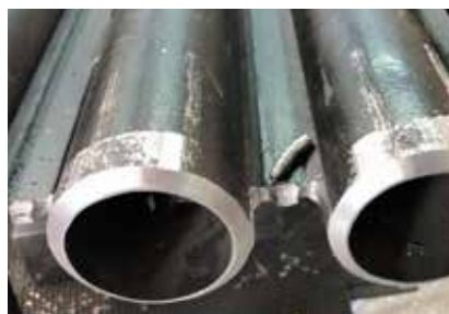
Aplicación retirada membrana en longitud 1".
