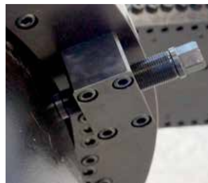
Pierścień ORR zamontowany na głównej ramie urządzenia, z boku prezentujemy wzmocnienia służące jeszcze lepszemu blokowaniu urządzenia na rurze.
