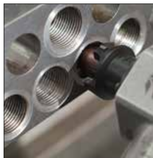
Obróbka powierzchni pod uszczelnienie trwa kilka sekund
