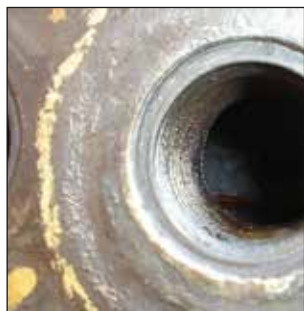
Gniazdo uszczelnienia przed obróbką
