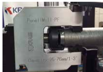
Usuwanie napawania na długości 25 mm
