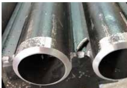
Usuwanie membran na głębokość 25 mm
